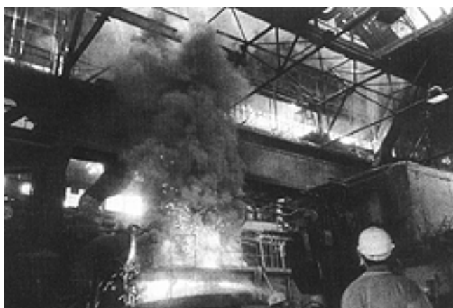
Obr. 4. Elektrická oblouková pec odsávaná pouze čtvrtým otvorem při intenzifikaci kyslíkem bez zákrytu víka.
