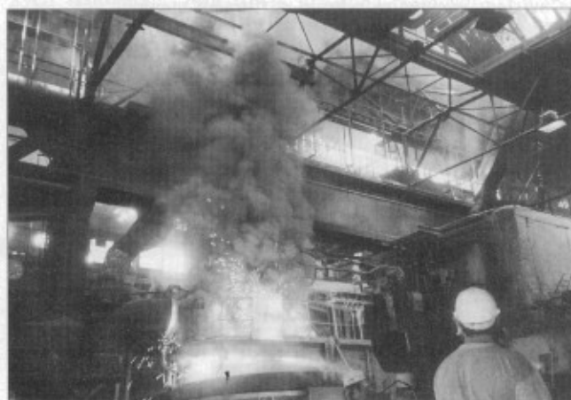
OBR. 4. Elektrická oblouková pec odsávaná pouze čtvrtým otvorem při intenzifikaci kyslíkem bez zákrytu víka. FIG. 4. Electric arc furnace exhausted only by the fourth hole with oxygen intensification without cover.
