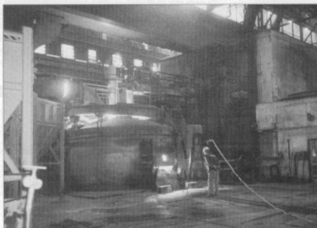
OBR. 3. Celkový pohled na pec při intenzifikaci kyslíkem s odsáváním zákrytu víka a čtvrtým otvorem. FIG. 3. General view of the furnace during intensification by oxygen with exhausting from the covering of the furnace cover and by the fourth hole.
